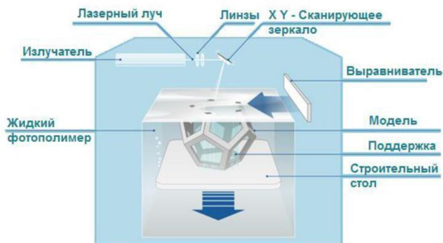
Рисунок 47 – Схема процесса SL
