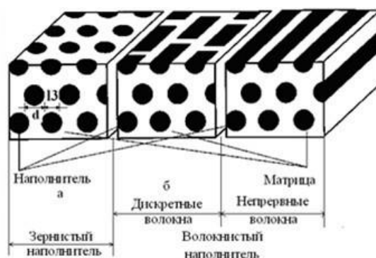
Рисунок 2 - Классификация КМ по виду наполнителя
