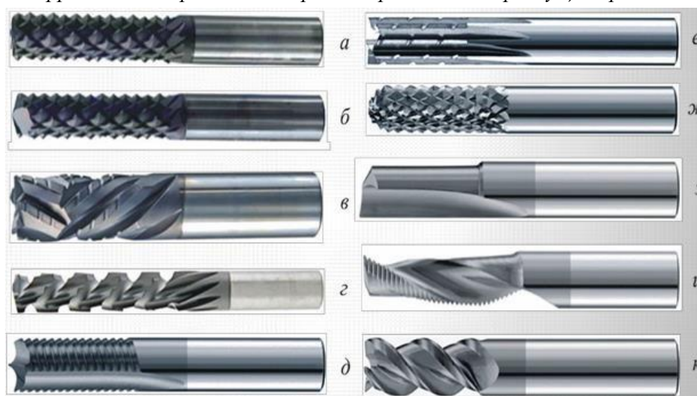
Рисунок 33 – Режущий инструмент для выполнения орбитального сверления
