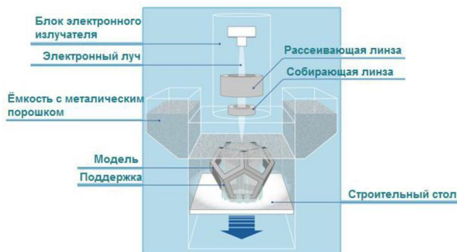
Рисунок 43 – Схема процесса EBM
