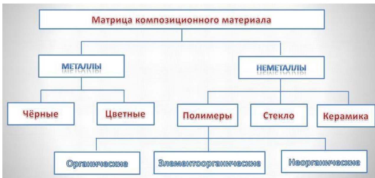
Рисунок 1 - Классификация КМ по виду матрицы
