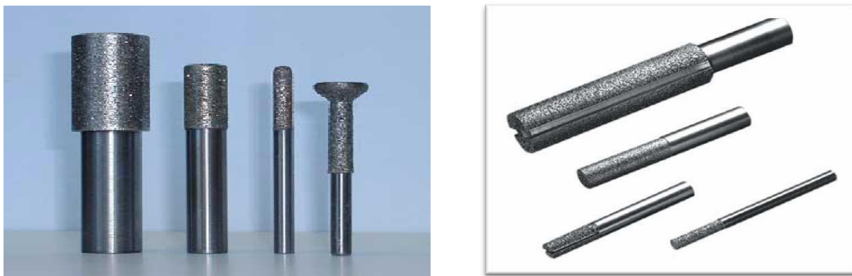
Рисунок 29 – Режущий инструмент с алмазным напылением для обработки КОМПОЗИТОВ
