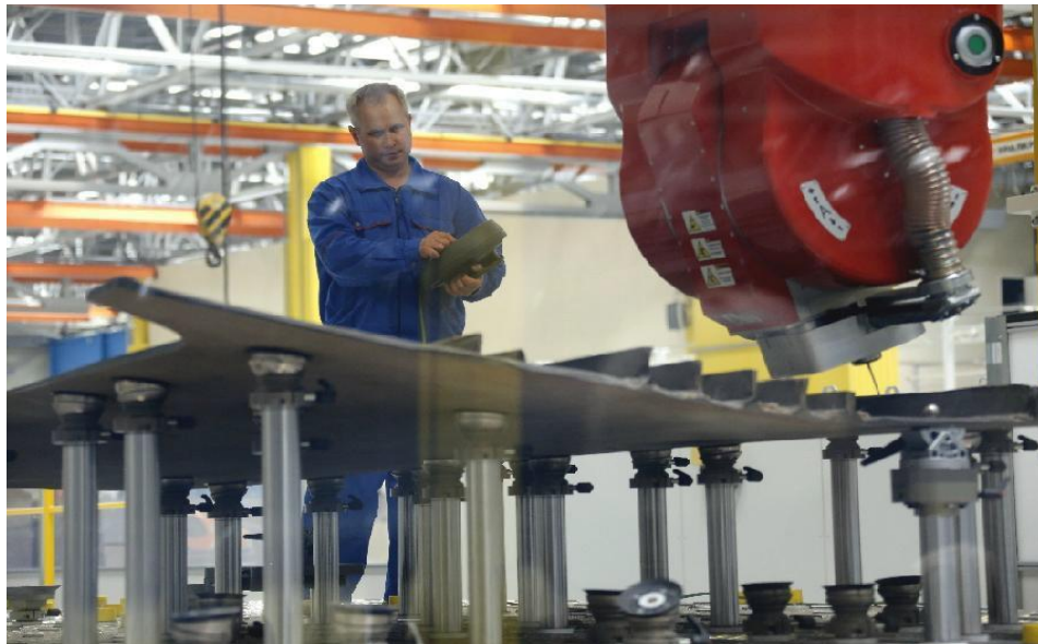
Рисунок 37 - Фрезерование на гибком столе (вакуумных актуаторах)
