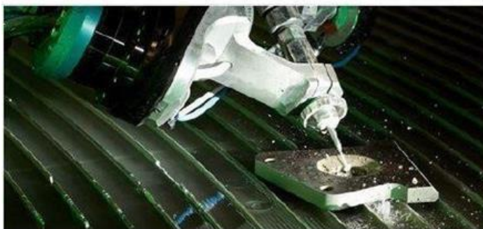
Рисунок 38 – Схема установки для гидроабразивной резки
