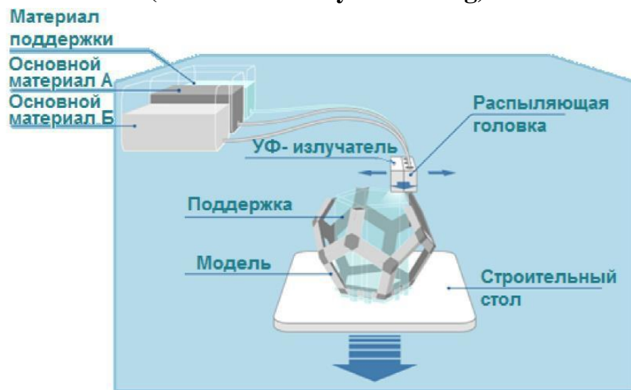
Рисунок 47 – Схема процесса PPJ
