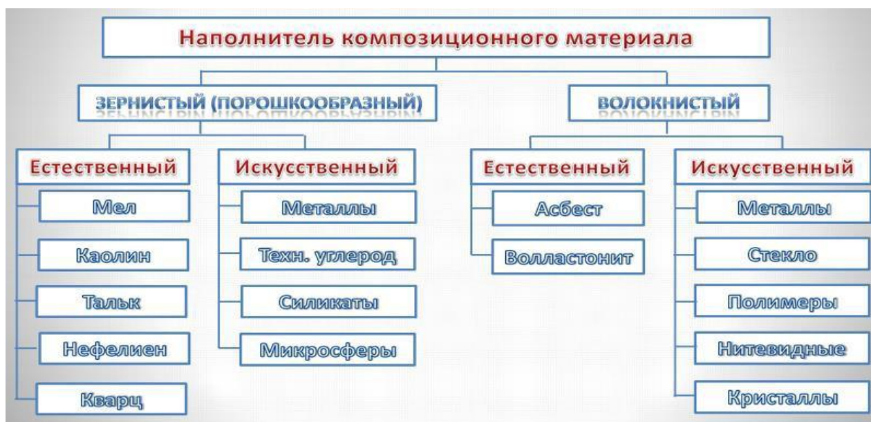
Рисунок 2 - Классификация КМ по виду наполнителя
