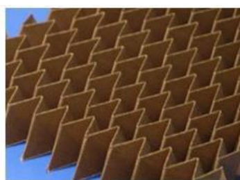
Образец наполнителя типа z-гофр из органопластика
