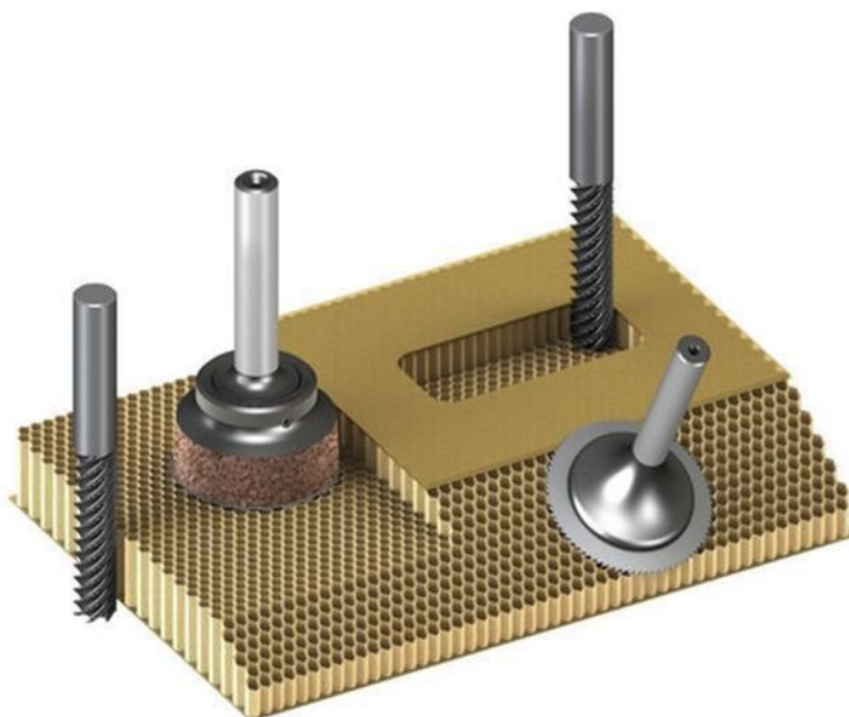
Рисунок 30 – Режущий инструмент применяемый при обработке сотовых конструкций
