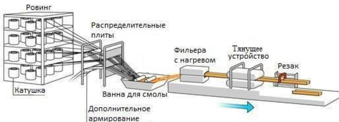
Рисунок 28 – Схема процесса пултрузии
